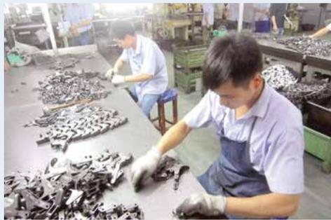
7月21日,农机链事业部制造车间开展了手装工劳动技能比赛活动。此次参赛的手装工共10位,竞赛分为串装和手检两部分,从速度、质量、技能、安全以及6S现场等方面计分,以两次的综合成绩来依次进行排名。为充分体现手装工甩榔头装配的水平,比赛选择了易产生紧节,对盖片要求相对较高,带凸包的CA555-C6E链条。
